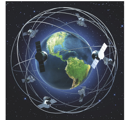
Figuur 44 Global Positioning System: 24 satellieten in 6 banen
